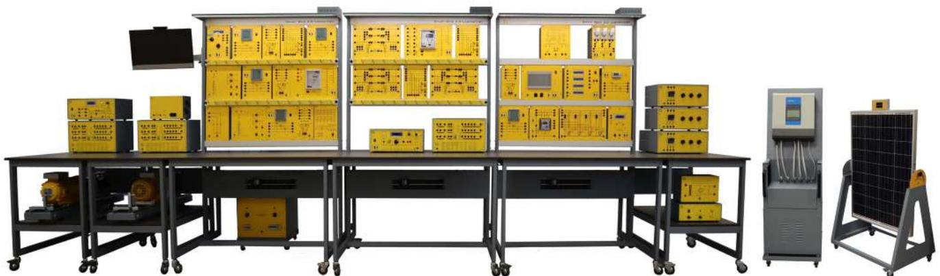
È un laboratorio che permette di studiare il flusso energetico e l'interazione con la rete elettrica (generazione, trasmissione e distribuzione) e le utenze (residenziale e commerciale). In poche parole, consiste in un modello di un sistema completo di distribuzione di energia elettrica.
