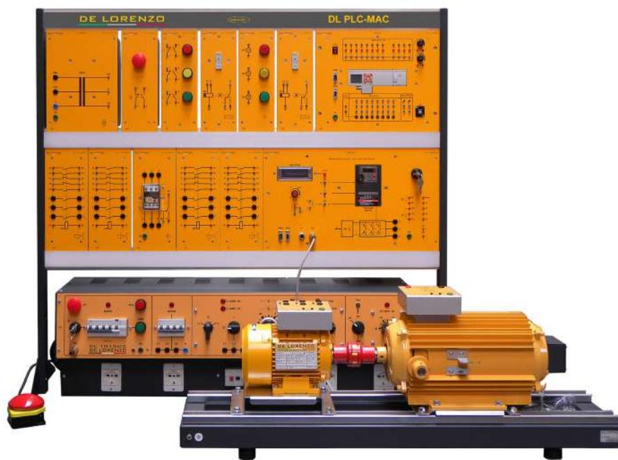
È un banco polivalente progettato per apprendere le tecniche di programmazione del PLC per avviare un motore asincrono trifase azionato da un inverter con controllo stella/triangolo manuale o automatico. Consente, inoltre, di studiare i componenti base utilizzati negli impianti elettrici, quali contattori, temporizzatori, relè termici, e di gestire componenti industriali quali PLC e driver a frequenza variabile per l'azionamento di macchine elettriche.
