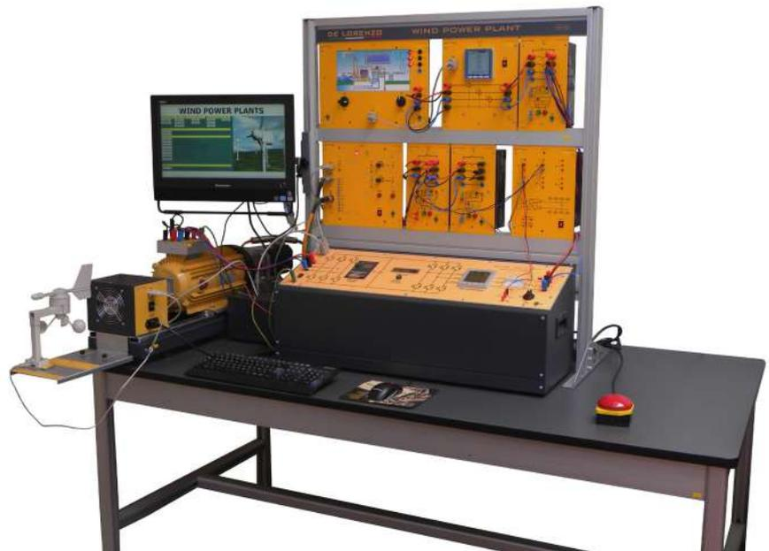
Sistema modulare progettato per consentire agli studenti di apprendere i principi di funzionamento di un moderno impianto eolico. Funziona con un motore brushless che aziona una macchina DFIG (Double-Fed Induction Generator) i cui avvolgimenti rotorici sono alimentati da un convertitore back-to-back per controllarne le caratteristiche elettriche.
