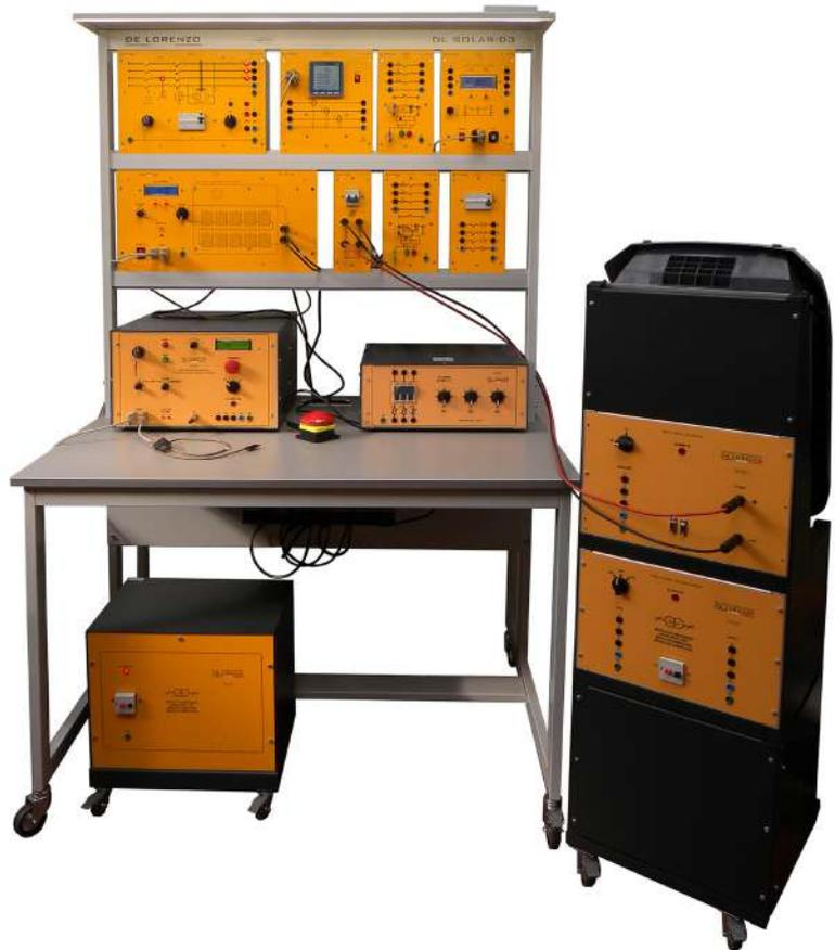
Sistema modulare progettato per consentire agli studenti di apprendere i principi di un impianto fotovoltaico e il funzionamento di un inverter solare trifase industriale collegato alla rete elettrica.
